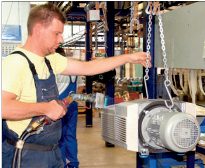
Der Bediener aktiviert die Kunststoffteile hier im Vorfeld durch Beflammen.
